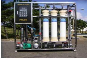
الصورة (7-1): جهاز Trihigh لتصفية المياه المستعملة المصدر: (2013) Water treatment systemsite
