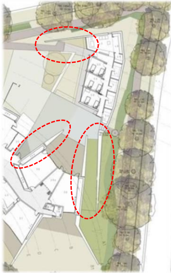
شكل رقم: 68 مخطط يوضح الجدران التي توجه الحركة الخارجية في المدرسة هازل وولد اسكتلندا المصدر: https://www.arch2o.com/hazelwood-2021/school
