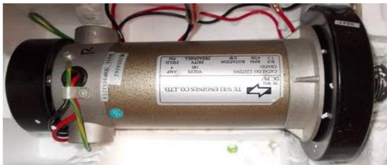
Figure 2 : Moteur TE WEI C8APB1 1,5 HP
