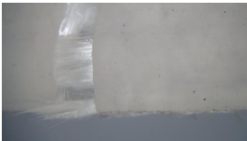
Figure III.31. Ligne de rupture de PP/verre sous l'effet de traction.
