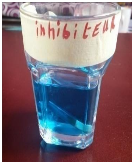
Figure II.3: Dispositif expérimental de la masse perdue
