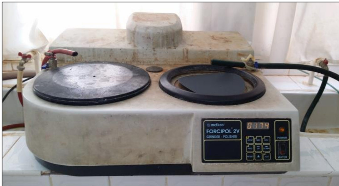
Figure II.1 : Schéma de polisseuse utilisé dans le polissage mécanique
