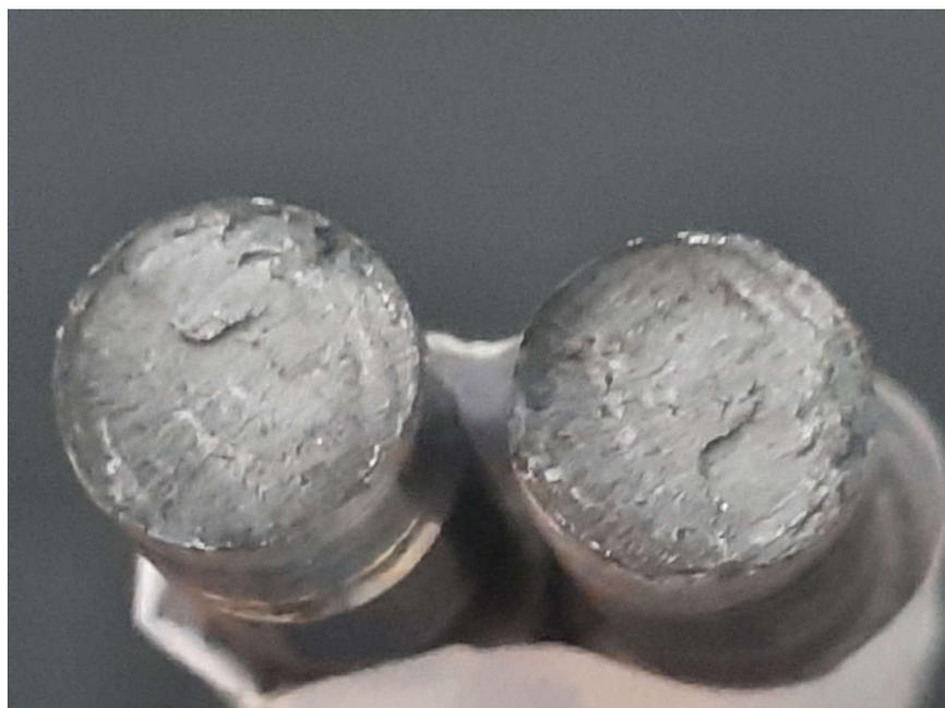
**Figure III.10-** Surface soudée après rupture (acier / acier)
