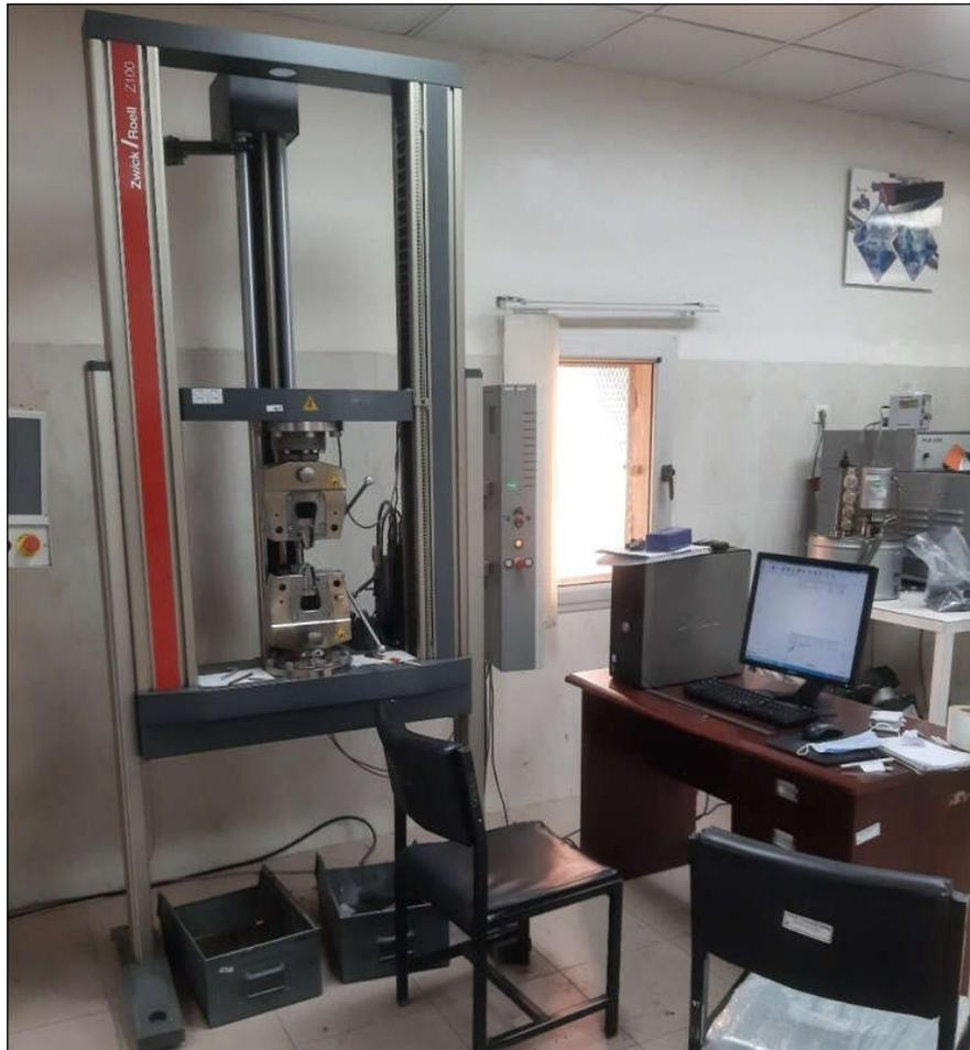
**Figure 3.2-** Machine de traction mécanique Zwick / Roell NF.EN 50182.
