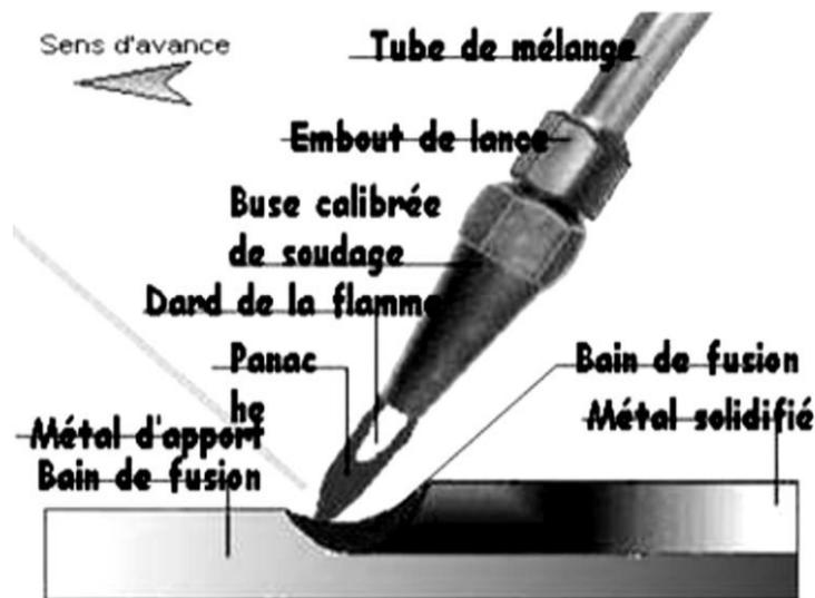
Figure I.6- Soudage au chalumeau [4].
