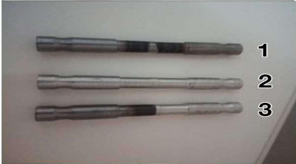
**Figure III.8-**Eprouvettes soudées.
