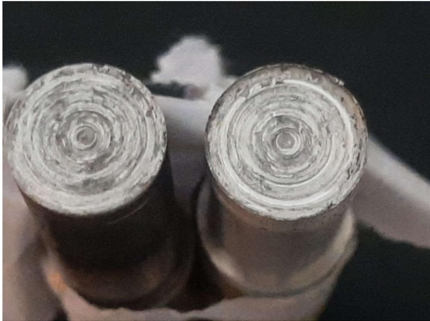
**Figure III.12-** Surface soudée après rupture (acier/aluminium)
