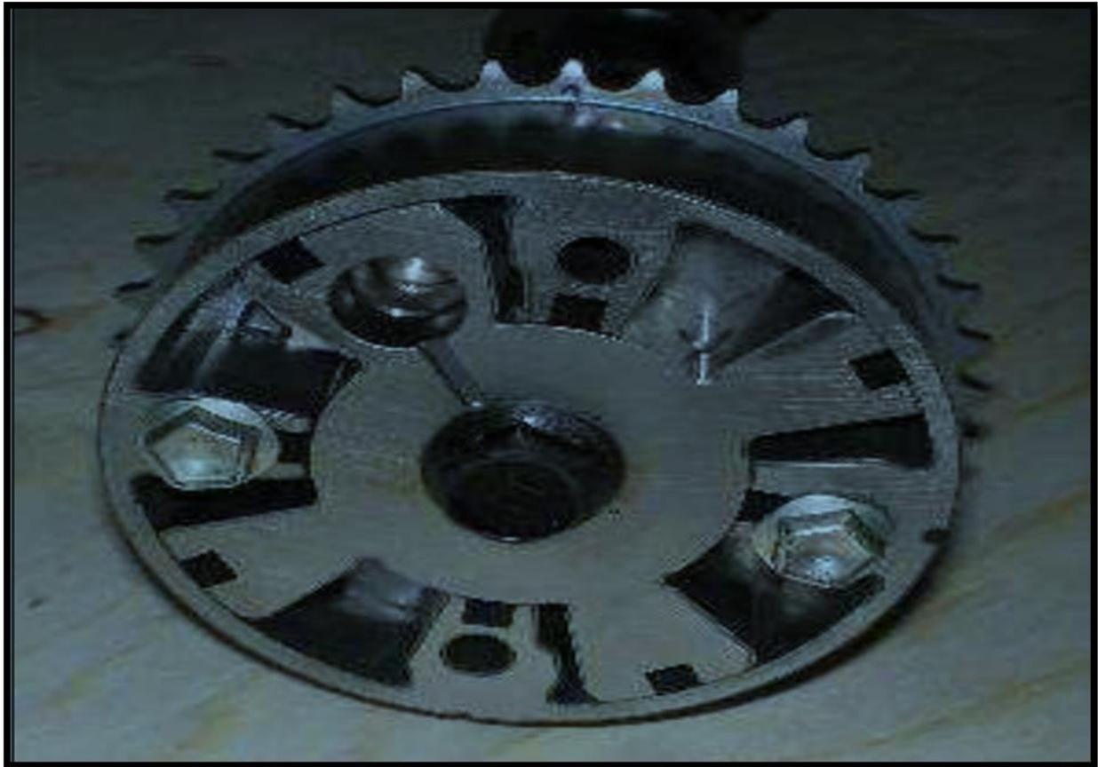
**Figure II. 9** Système d'avance hydraulique de came. [13]
