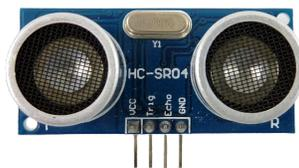
FIGURE IV.16 – Capteur ultrasonique.
