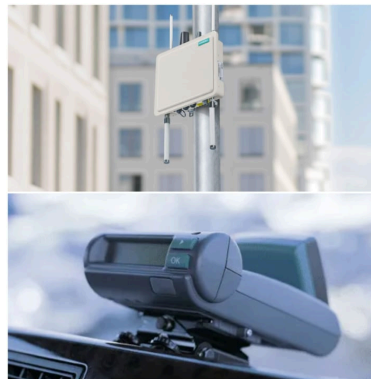
FIGURE 1.2 – Les dispositifs RSU et OBU
