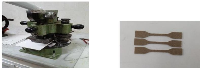
**Figure II.9 :** Le découpage des plaques sous forme d'haltères
