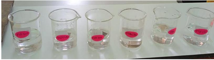
**Figure II.13 :** Test d'absorption d'eau pour les composites PELBD/ Fibres de noix.
