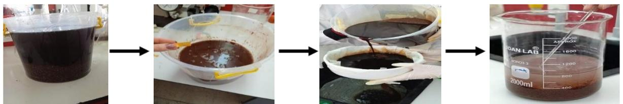
Figure II.3 : Modification chimique de la farine de noix par la soude NaOH.
