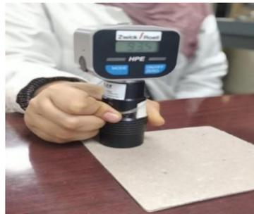
**Figure II.11:** Duromètre HPE Zwick-Roell.
