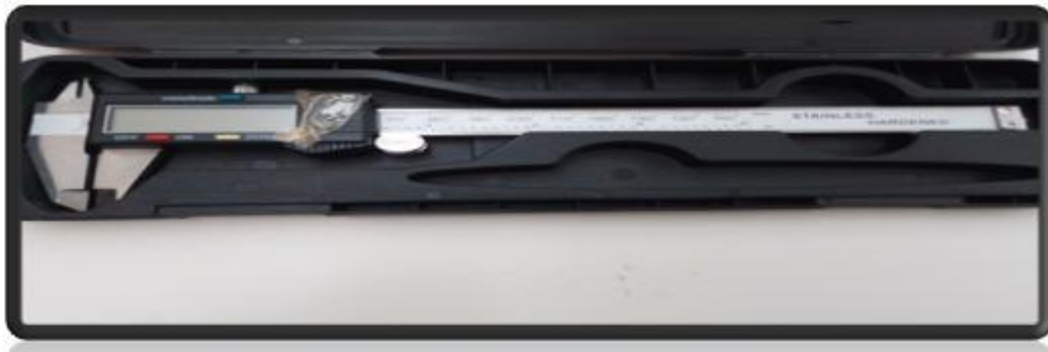
Figure II.15 : Pied à coulisse électronique.
