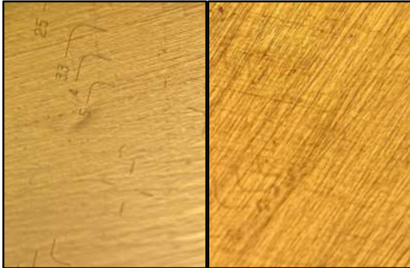
Figure III- 10 : Micrographie par le microscope (grossissement X10) de l'acier X70 avant immersion
