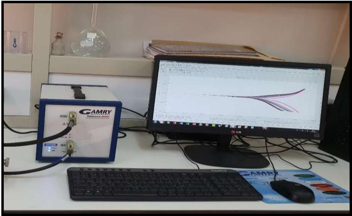
Figure II- 5 : Photo du dispositif expérimental utilisé pour les mesures électrochimiques.
