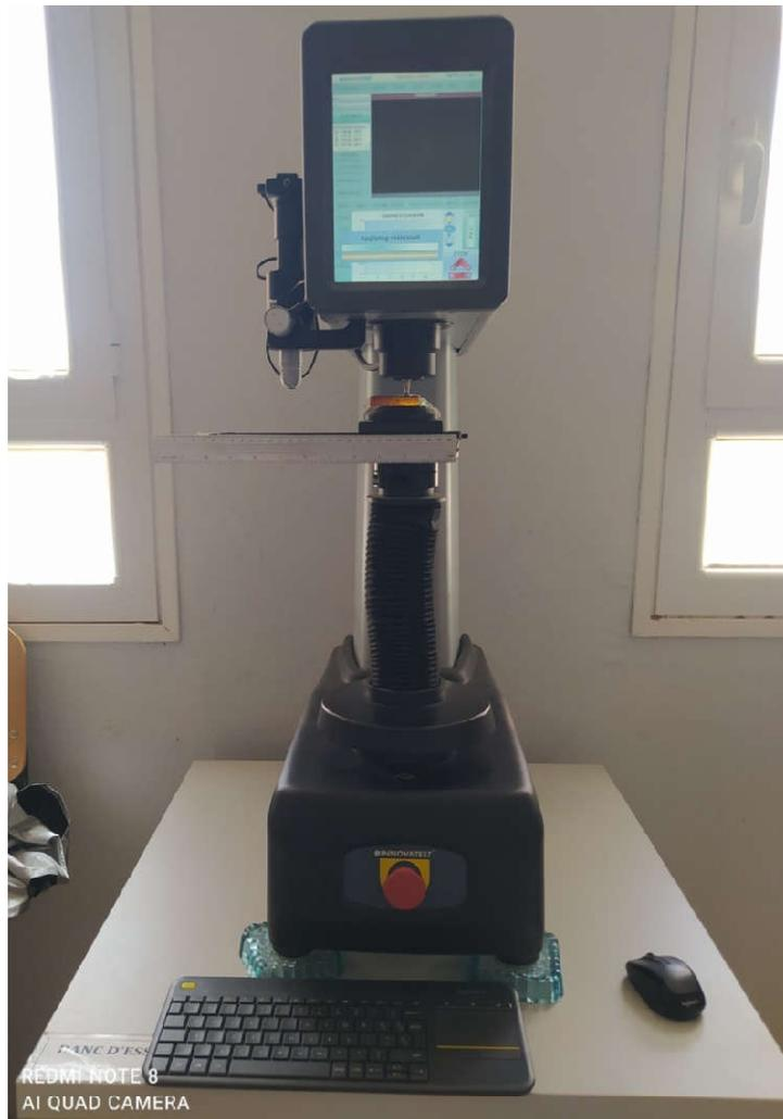
**Figure III .7.** Microduromètre de type INNOVATEST.
