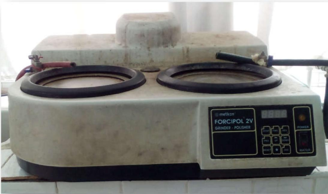
**Figure III.4 :** Polisseuse de type Forcipol.
