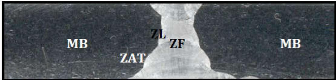
**Figure I.5.** Microstructure du joint soudé[8].
