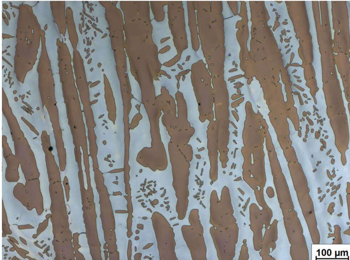
**Figure II.5.** Microstructure typique des aciers inoxydables duplex[2].
