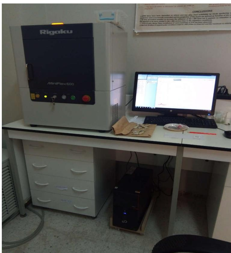
Figure II.7: Diffractomètre des rayons X « RIGAKUMini Flex 600 »
