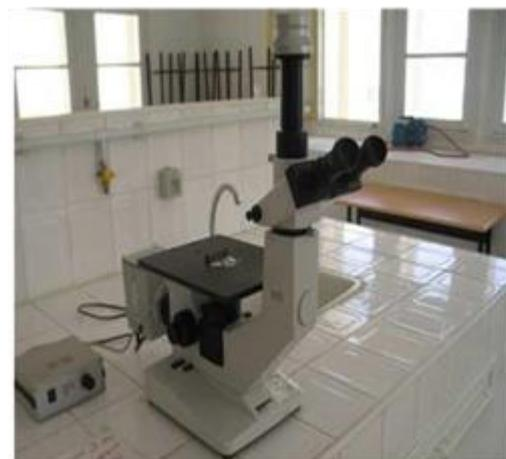
Figure (II.8) Microscope optique HUND T100-
