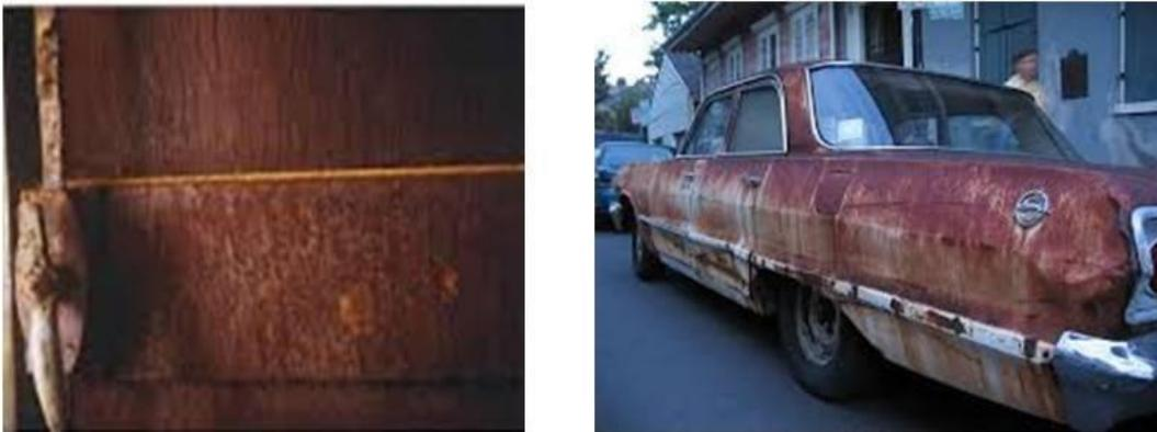
**Figure I-3 :** Corrosion généralisée : exemple d'une porte et d'un véhicule corrodés.
