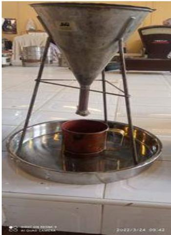
**Figure 2-2** Mesure de la masse volumique apparente
