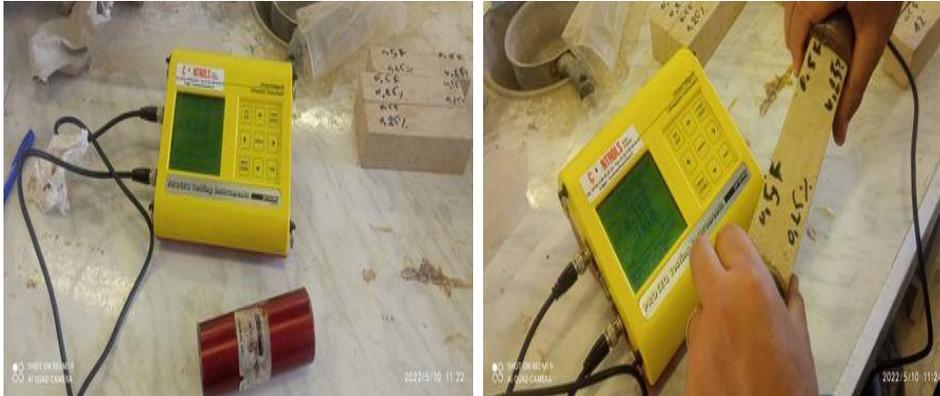
**Figure 2-21** Mesure de la vitesse de propagation.
