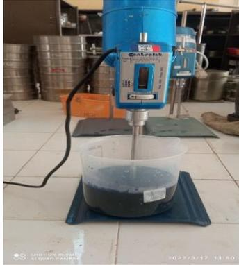
**Figure 2-8** Essai de bleu méthylène.
