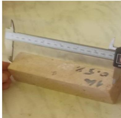
**Figure 2- 20** La mesure des dimensions de la brique à l'aide de pied à coulisse électronique.
