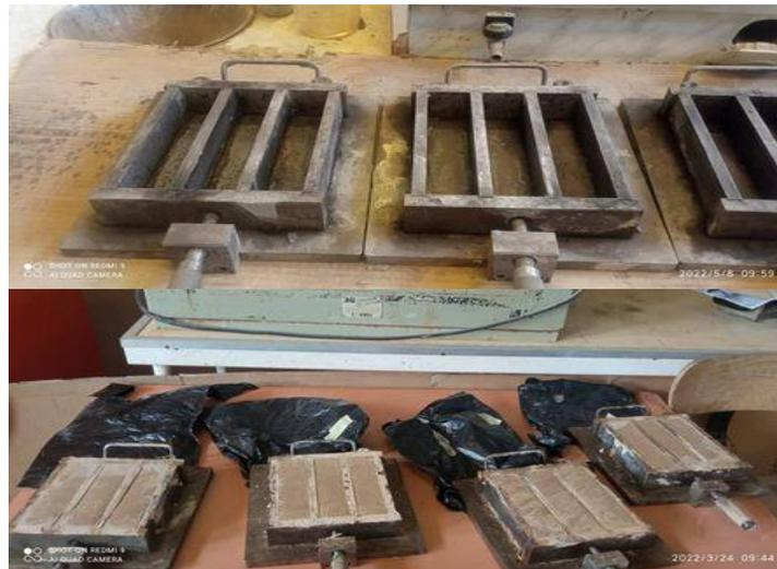
**Figure 2-13** Les moules utilisés pour les essais mécanique
