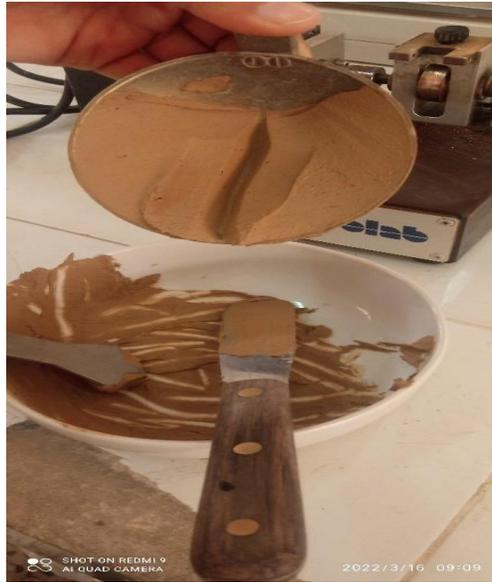
**Figure 2-5** Essai de limite de liquidité.
