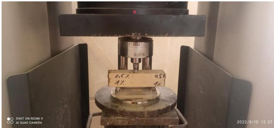
**Figure 2-19** Essai de traction par flexion.
