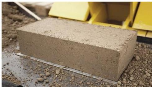
**Figure 1-10** Brique de terre comprimée (<https://www.lamaisonnature.ch/wp-content/uploads/2009/06/compressed-earth-block.jpg>).
