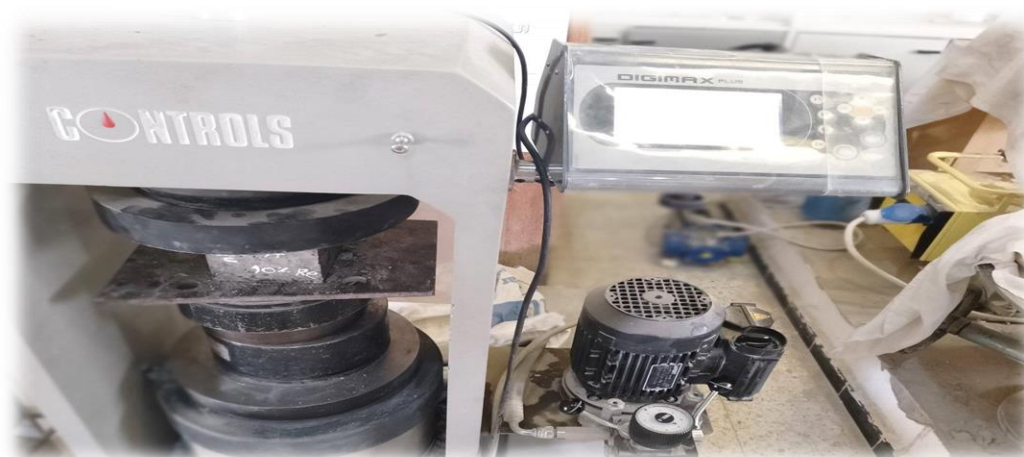
Fuguer 07-Appareil d'écrasement des éprouvettes.
