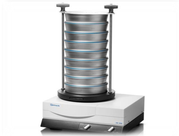
Fuguer 04-La machine à tamiser
