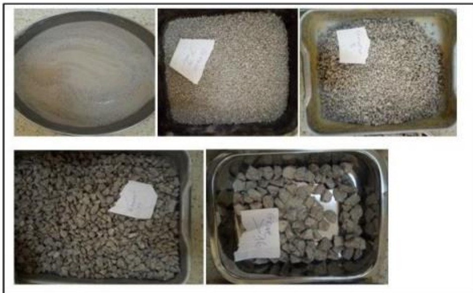
Fuguer 03 -Différentes fractions granulaires récupérées
