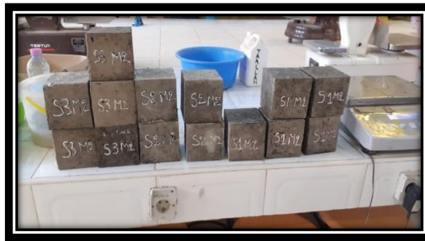
Figure III.1: Echantillons après immersion dans l'eau après 28 jours.
