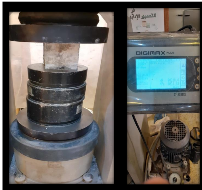
Figure II. 9: La machine pour essai de compression et affichage de la résistance.
