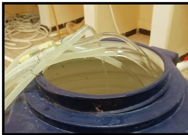
*Figure IV.6 : Bac d'accumulation utiliser pour mesurer les débits soutirés*
