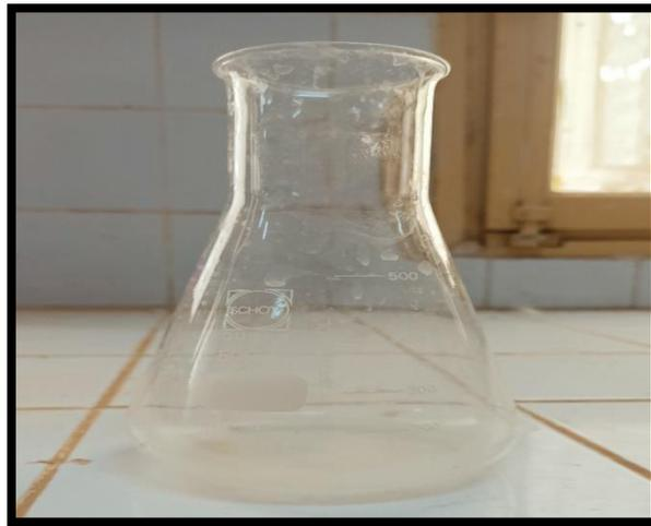
*Figure IV.7 : Becher (0.5 l) utiliser pour mesurer les débits soutirés.*
