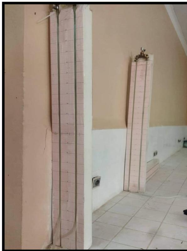
*Figure IV.8 : Piézomètre utilisé.*
