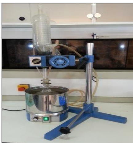
Figure 4 : Montage utilisé pour l'activation chimique des noyaux d'olives (Laboratoire LARHYSS, U. Biskra).
