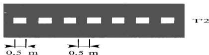
FigureVII.6 : Lignes transversales (source S -H partie 1-7)
