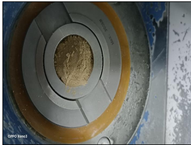
Figure III.4 : pastille de farine après la calcination
