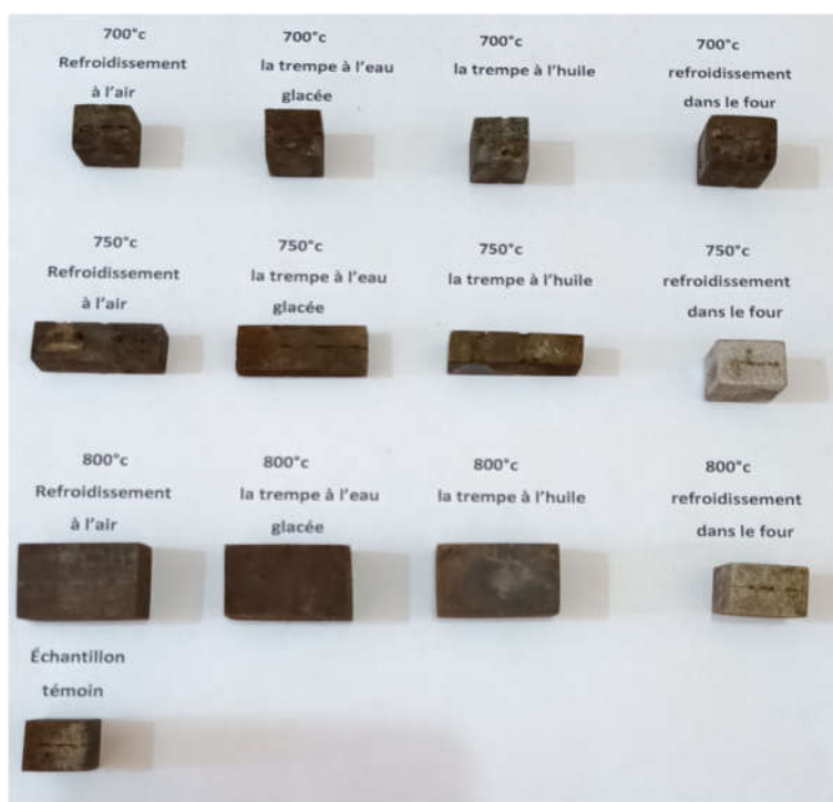
Figure III.15 : les 13 échantillons après 23 jours d'immersion dans HCl après le nettoyage.
