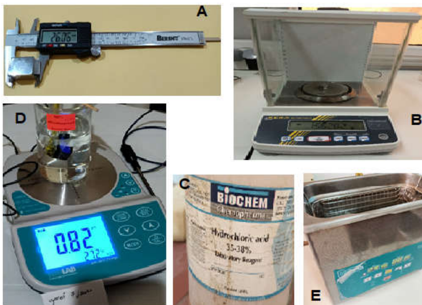
Figure III.11 : A: pied à coulisse électronique, B: balance à quatre chiffre, D: pH-mètre et agitateur, C: Acide chlorhydrique, E: Bac à ultrason
