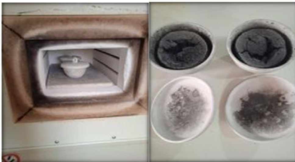
Figure IV.6 : Noyaux de fruits de Lilas perse après carbonations dans un four à moufle de type DAIHAN Scientific.
