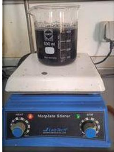
Figure IV.7 : Lavage du biochar avec HCl
