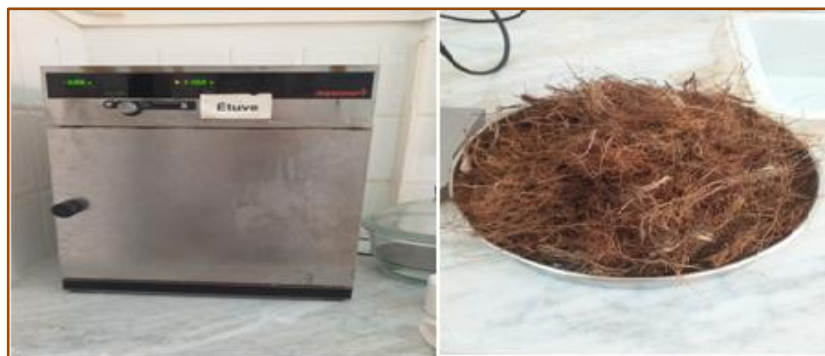
Figure III.6 : séchage de fibre de palmier dattier ( t = 48 heures ; T = 60^{\circ}\text{C} )
