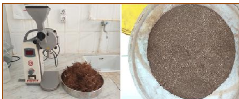
Figure III.7 : broyage de fibre de palmier dattier
