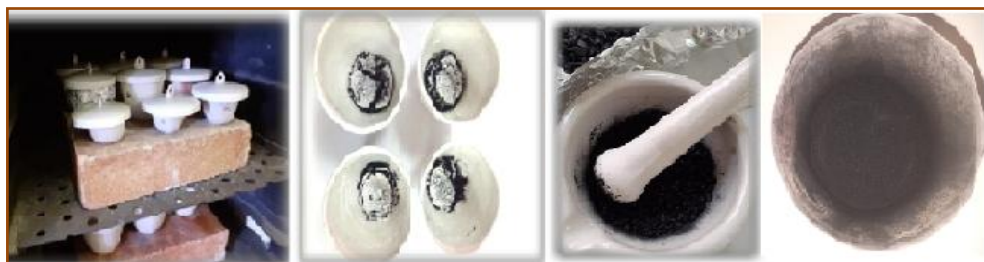
Figure III.8 : La carbonisation de fibre de palmier dattier séchés dans un four à moufle à ( T=600^{\circ}\text{C} pendant 3 h)
