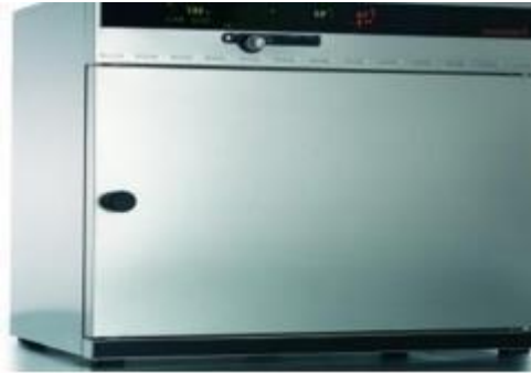
Figure III.5 : le séchage de fibre de palmier à une température (T=110°C)
