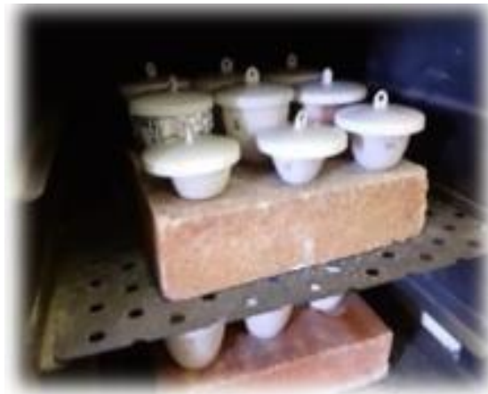
Figure III.8 : la carbonisation dans un four à moufle T=600°C pendant 3h
