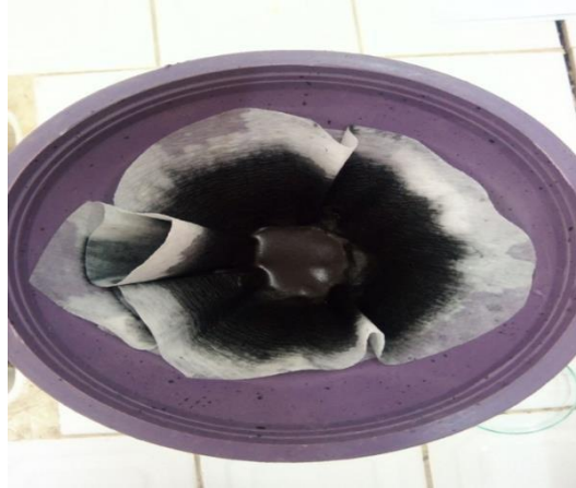
Figure III.9: lavage par NaOH .
