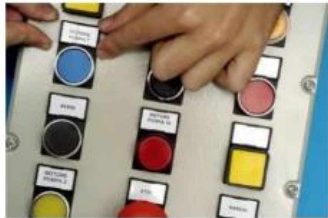
Figure II. 11 Différents types de boutons poussoirs [8]
