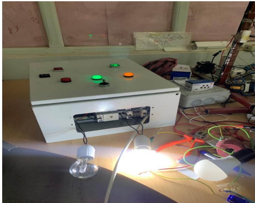
Figure III. 14 Essais par des lampes la commande de arduino
