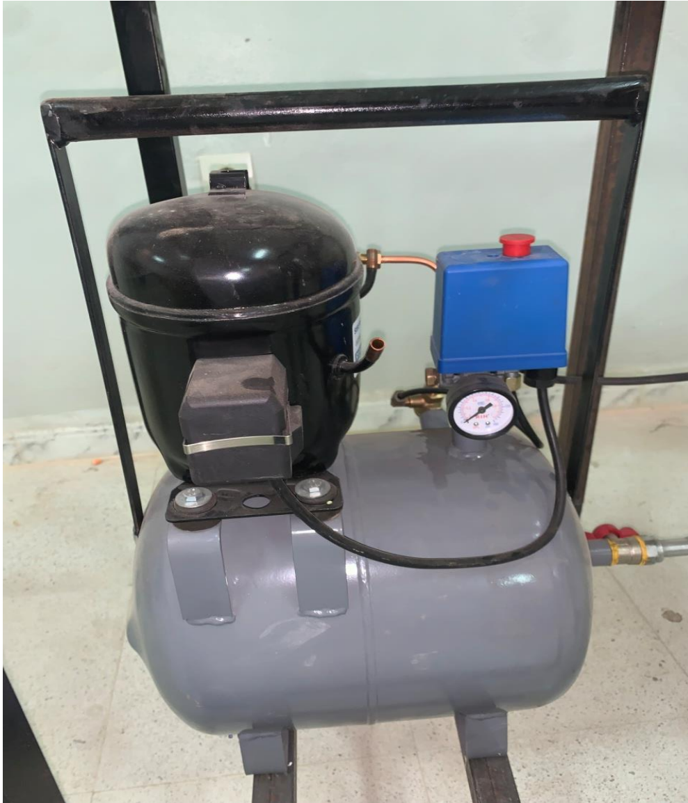
Figure III. 5 Compresseur de 6 bar
