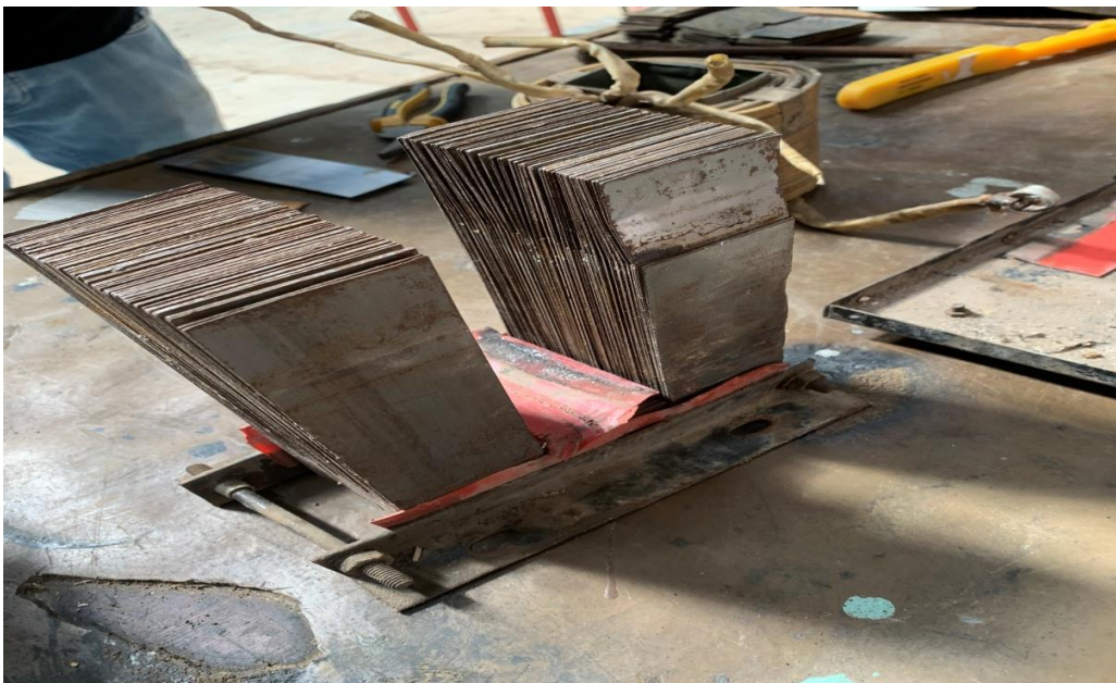
Figure III. 3 Début de fabrication de transformateur
