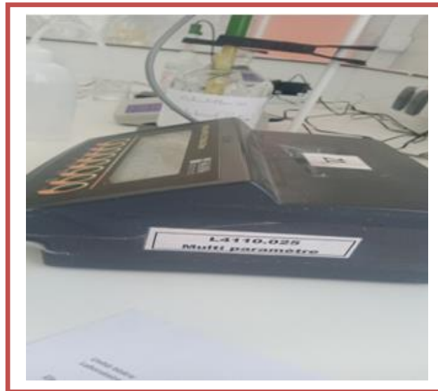
Figure III.4: Mesure de Conductivité, TDS et salinité.
