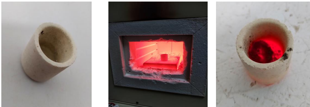
Figure III.10 : Les étapes de détermination de la PAF
