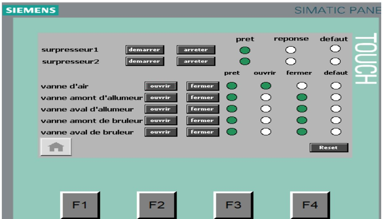
Figure IV.57 : vanne d'air ouverte
