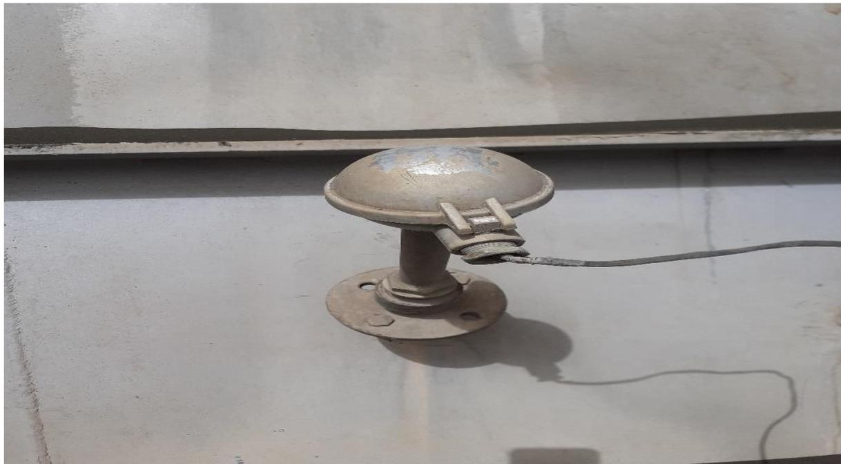
**Figure III.6 : thermocouple**
