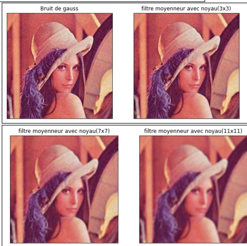
Figure III. 25 : Résultats du filtre moyenneur pour l'image de lena bruitée avec gauss
