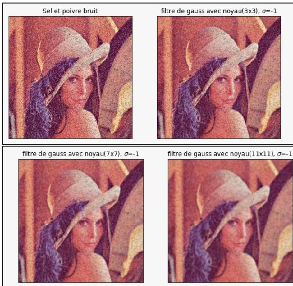
Figure III.22 : Résultats du filtre de gauss pour l'image Lena bruitée avec sel et poivre
