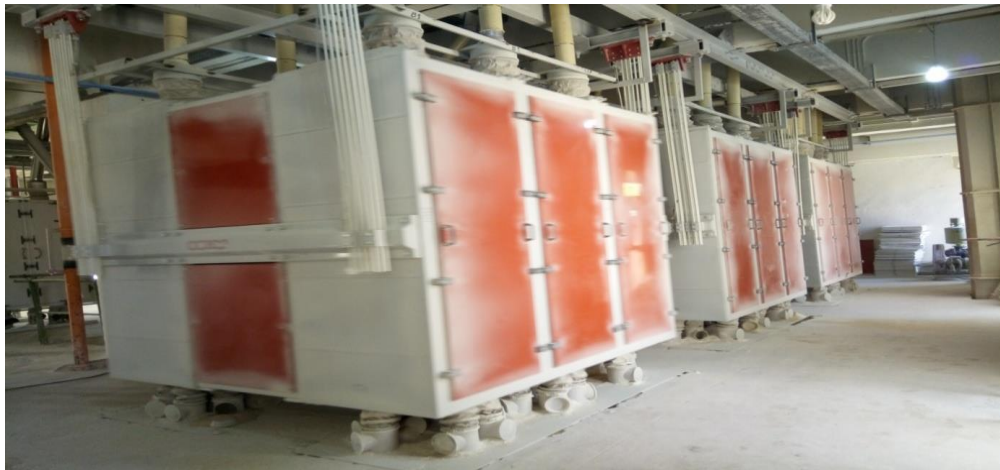
Figure n°12: Planschister(les Moulins des zibans, 2022)
