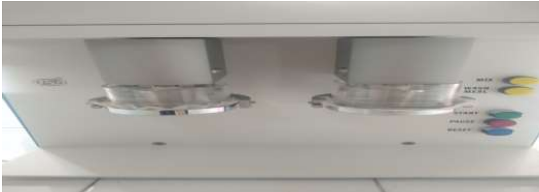
Figure n°24 : Centrifugeuseessoreuse de gluten (photo originale).
