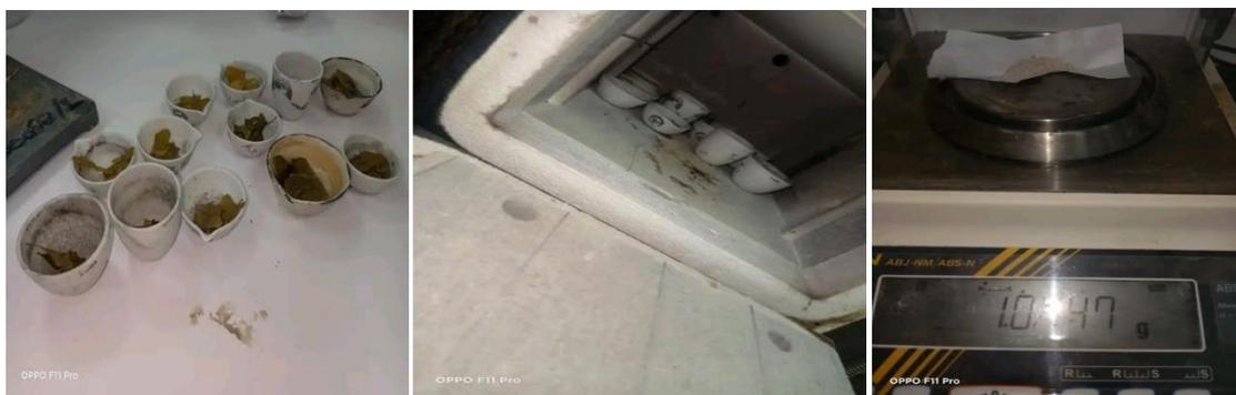
**Photo 09:** mesure du poids d'amendement matière végétale avant et après par calcination (originale, 2022)
