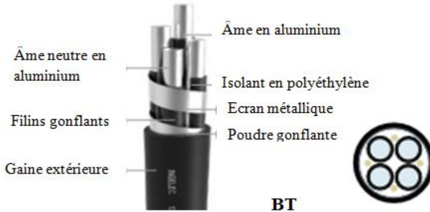
Figure 1.1: Les câbles Souterraines BT.[2]
