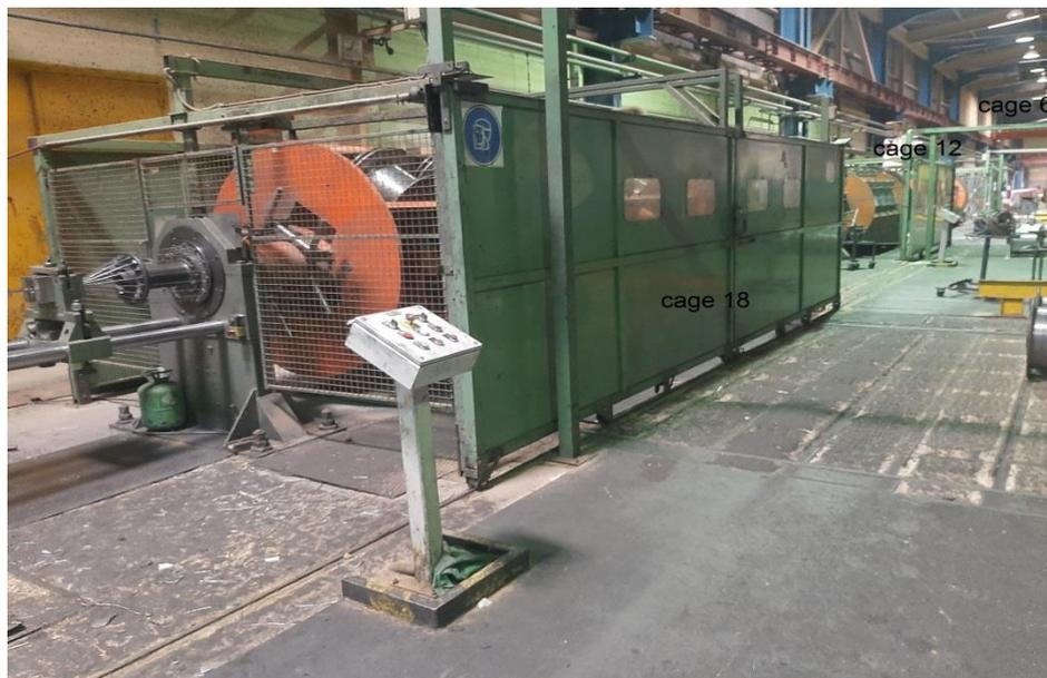
Figure 2.9: La machine de câblage.
