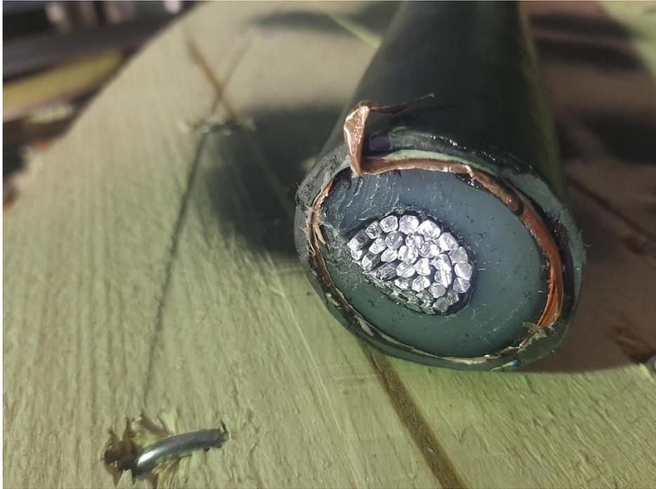
**Figure 2.23:** Cable électrique 1X185 mm<sup>2</sup> MT Alu 18/36(KV).
