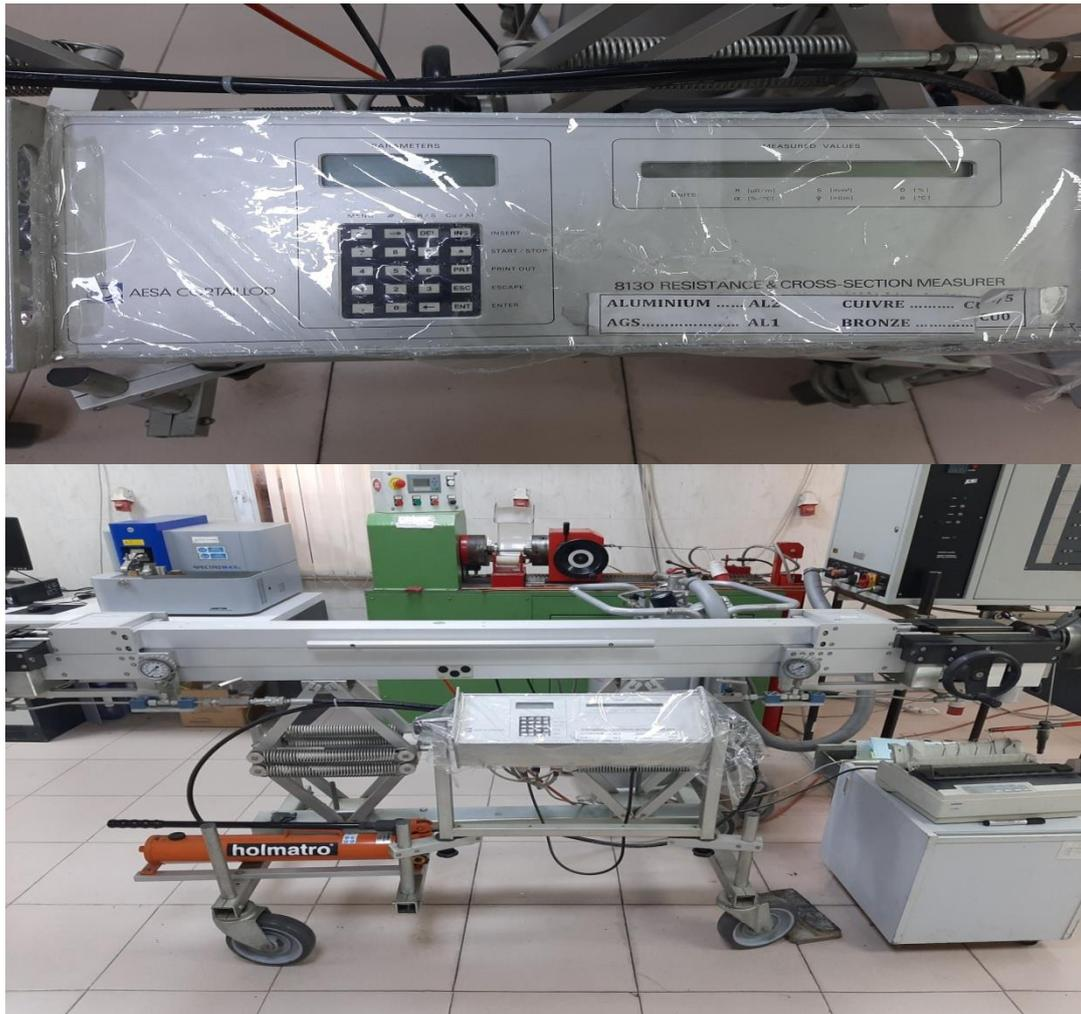
**Figure 3.3:** La machine de calcul la Résistance Linéique à 20°C.
