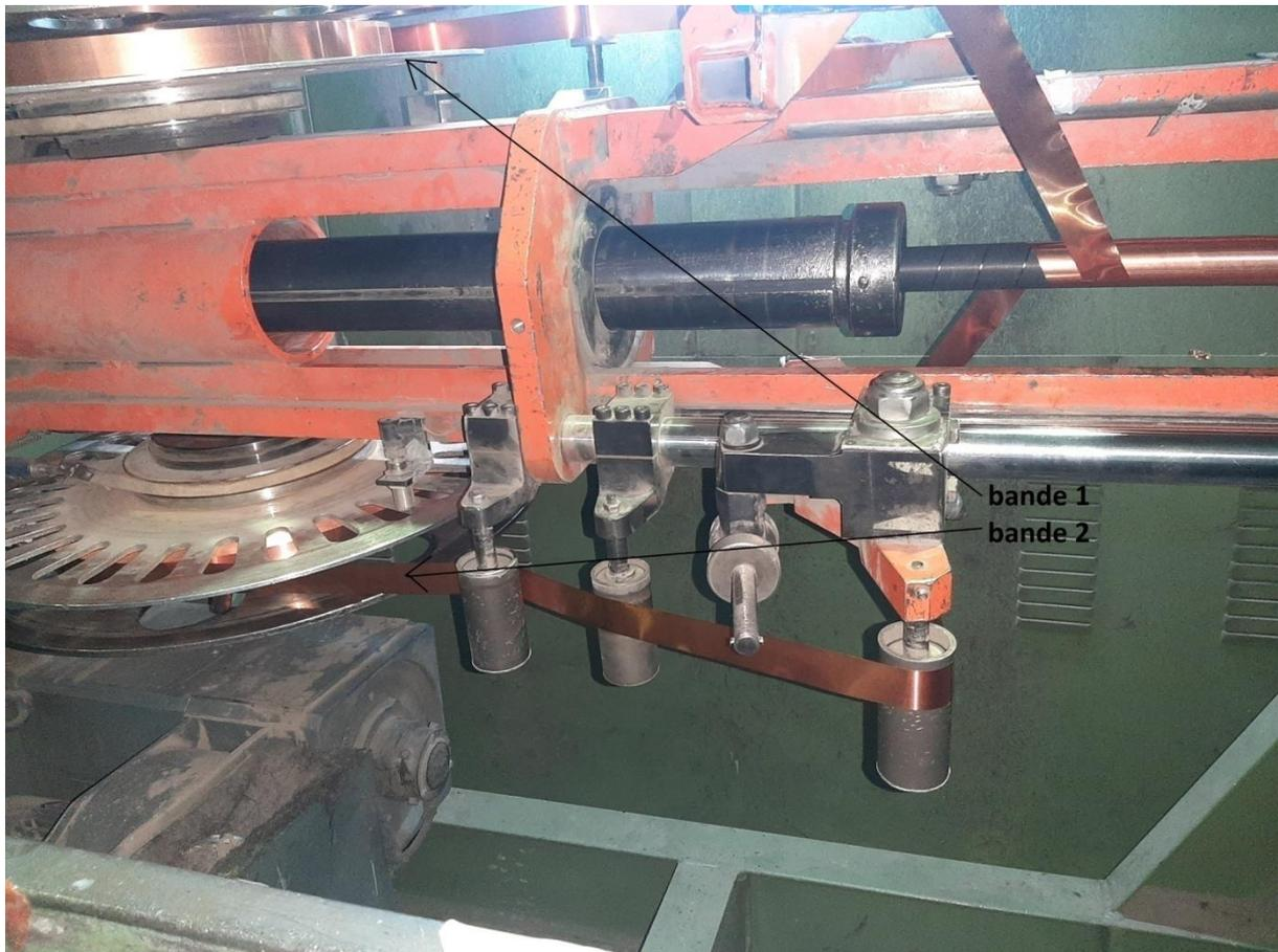
Figure 2.17: Méthode de pose l'écran métallique en cuivre.
