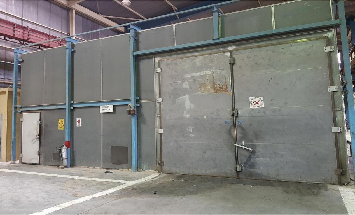
Figure 3.6: La cage de Faraday pour l'essai de décharge partielle (Pc)
