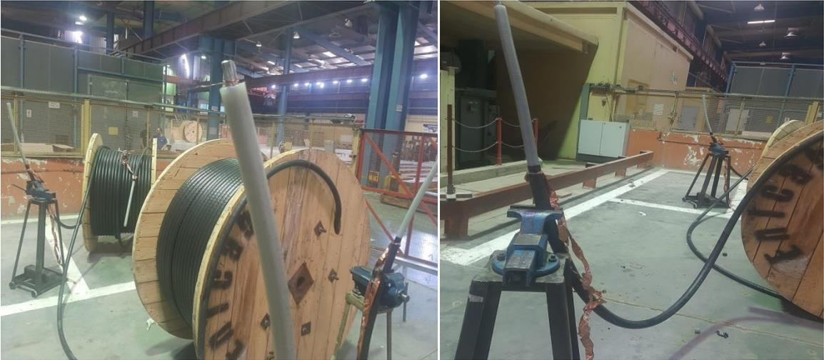
Figure 3.5: La méthode d'essai de décharge partielle (Pc)
