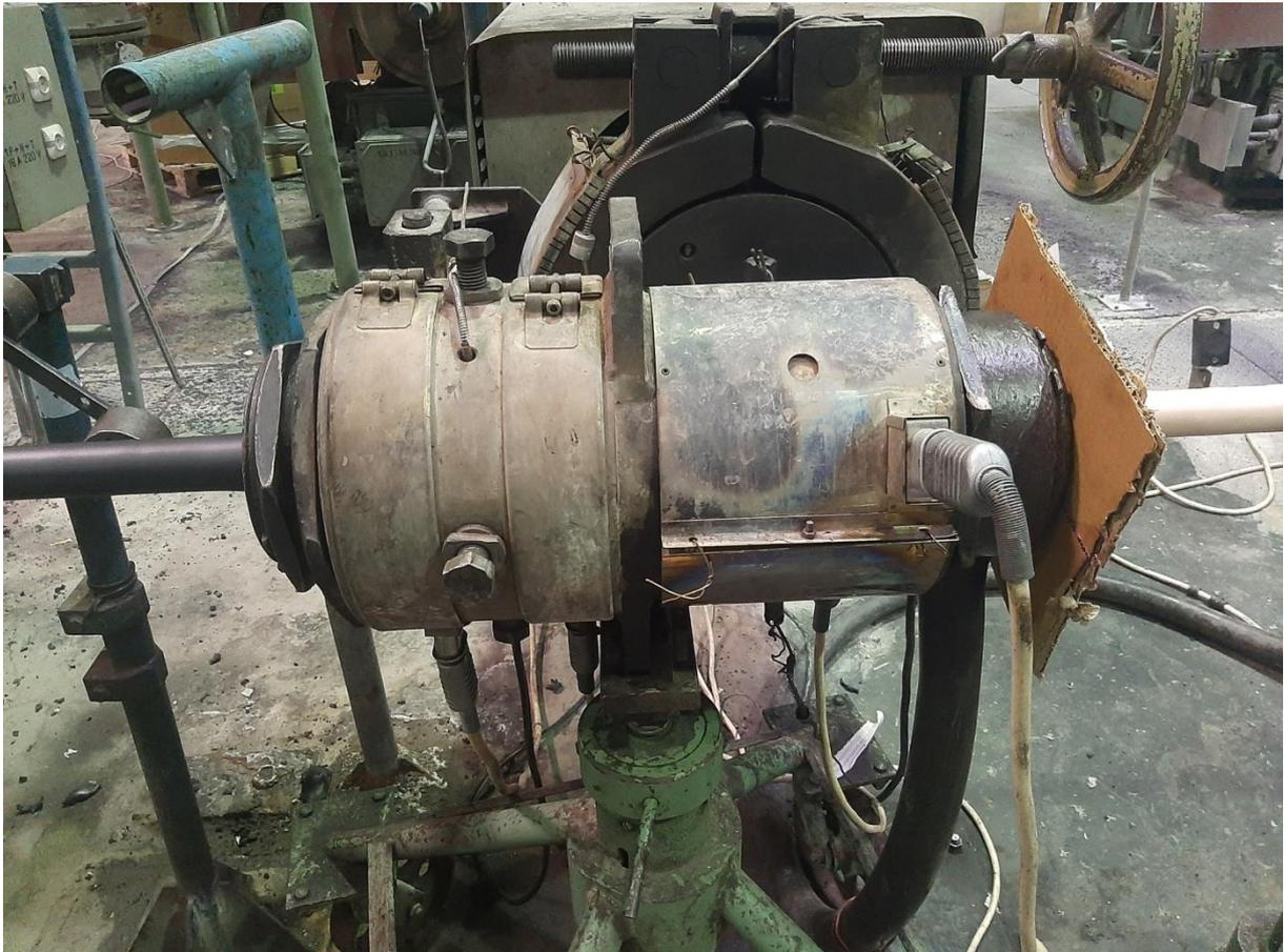
**Figure 2.20:** Extrudeuse de pvc.
