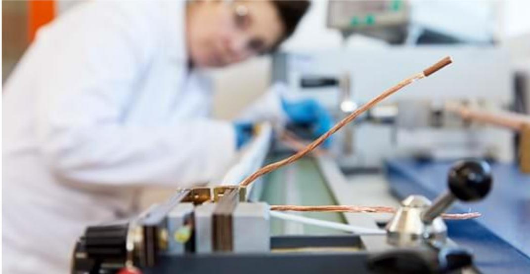
**Figure 3.4:** La méthode de calcul la Résistance Linéique à 20°C.[8]
