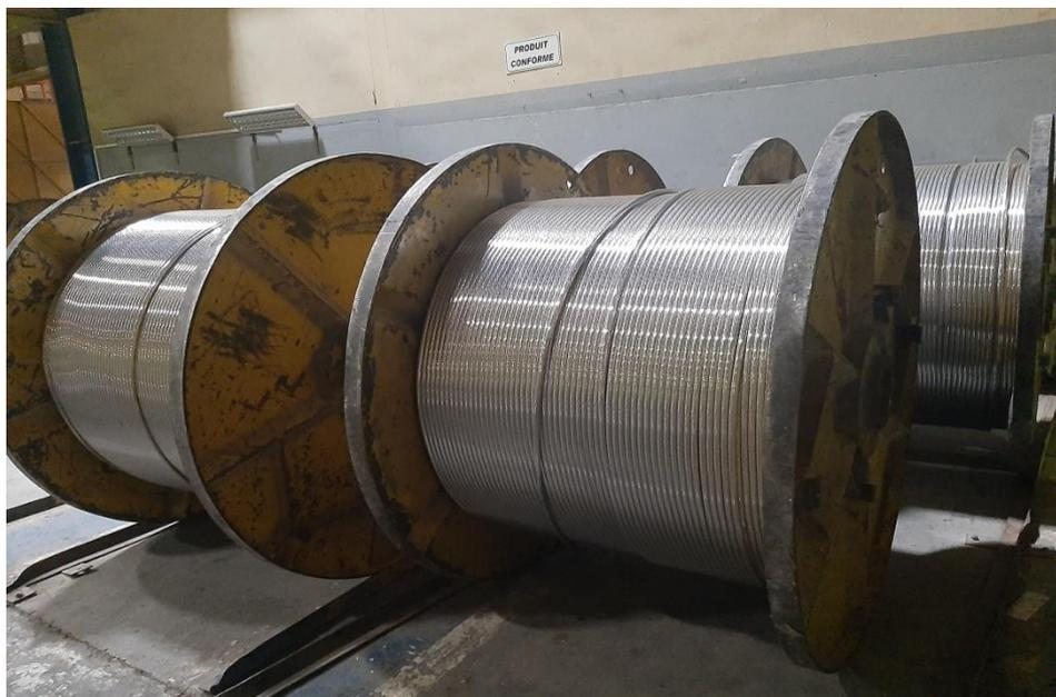
**Figure 2.11:** Produit confort après le câblage 185 mm<sup>2</sup> Alu.
