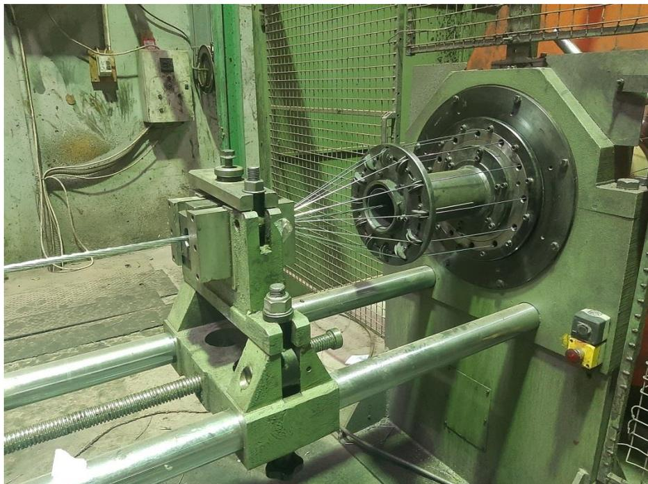
Figure 2.7: 2<sup>eme</sup> cage 12, câblé 12 fil de 2.6  $\varnothing$ + (7x2.6 $\varnothing$ ) come centre.
