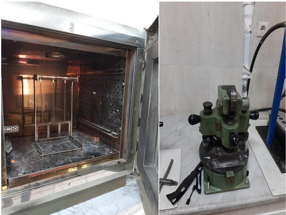
**Figure 3.1:** Essai d'allongement à chaud sur PR
