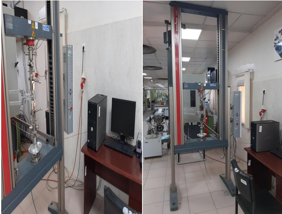
**Figure 3.2:** La machine de traction et d'allongement pour les matériaux d'isolation.
