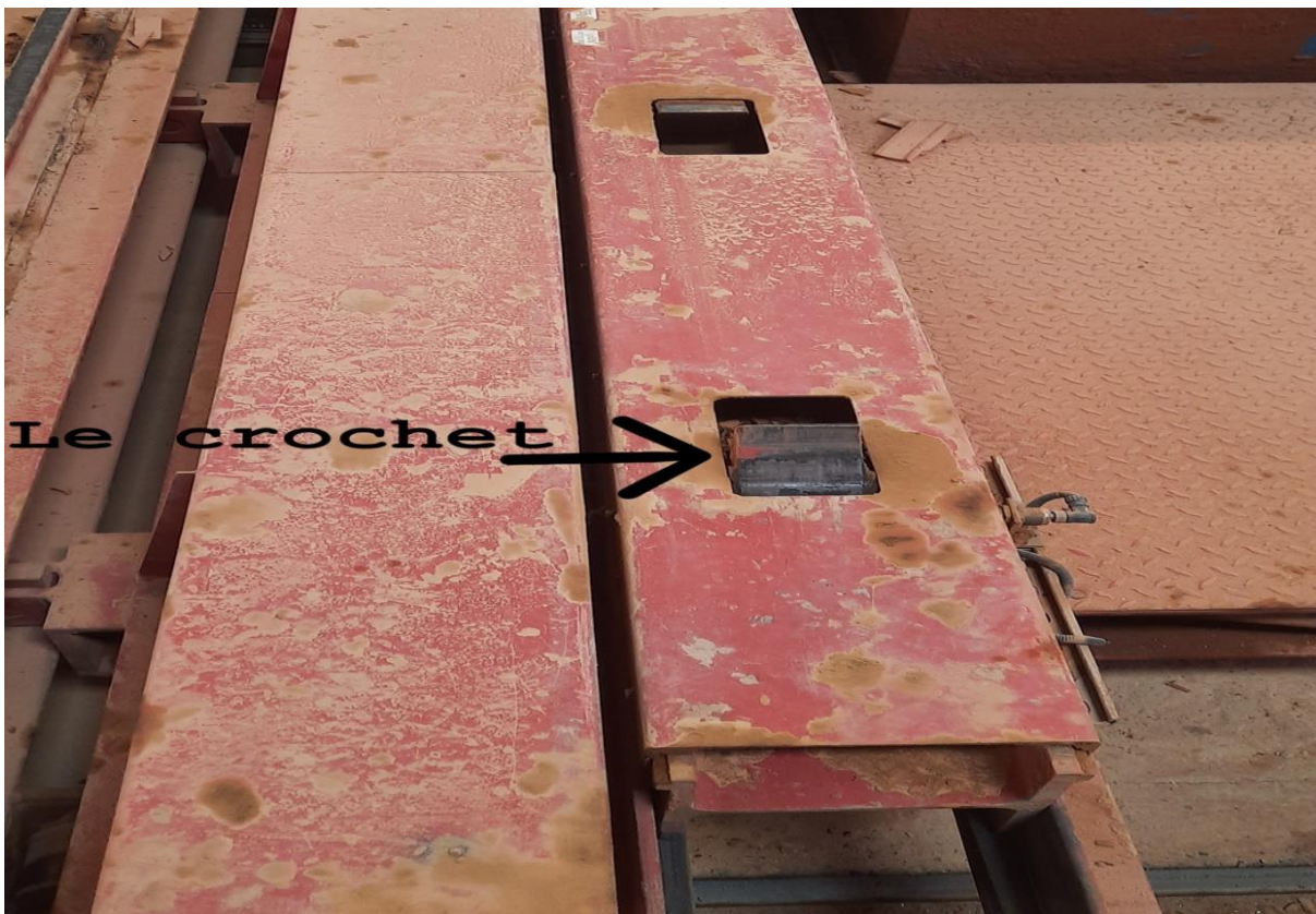
Figure III-6. Le crochet sur le transbordeur
