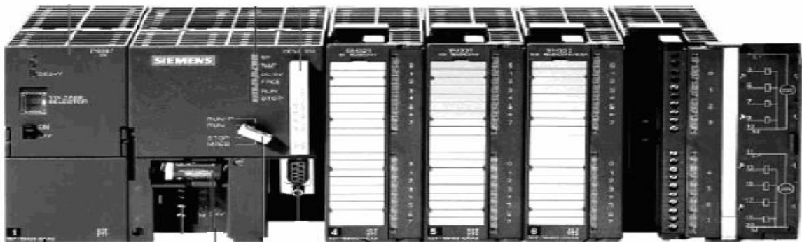
Figure II-2. Automate modulaire (Siemens) [11].
