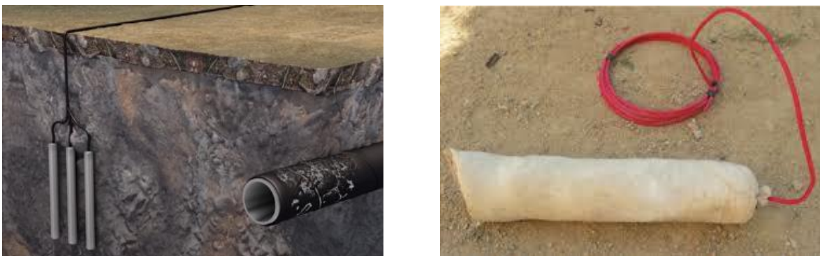
figure III 14: les anodes et la façon dont elle est positionnée.
