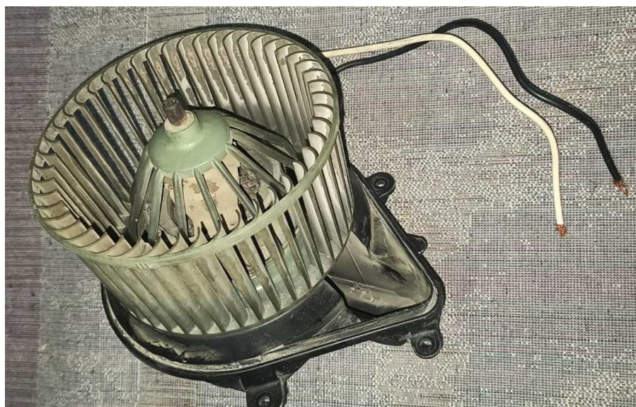
Fig. III.1. Un moteur d'un ventilateur de climatiseur
