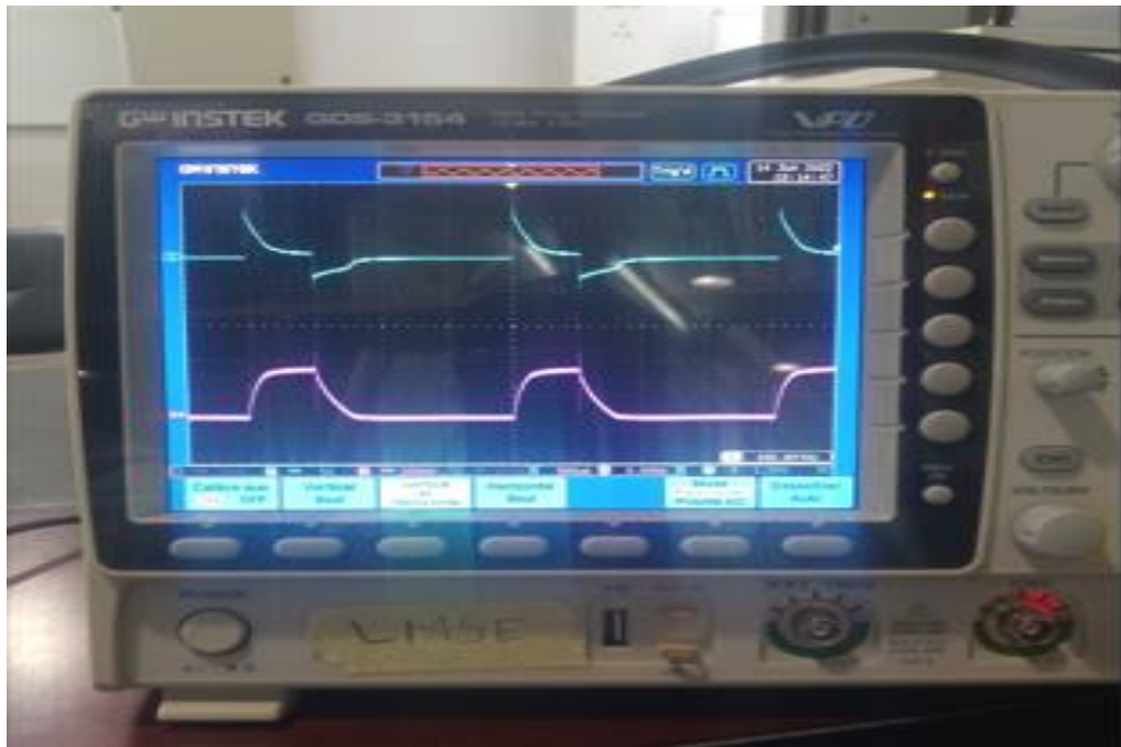
Fig.III.12 Courant et tension mesurés au bornes du moteur
