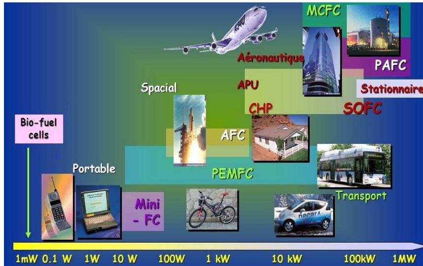
Figure I.6- Les Application de piles à combustibles
