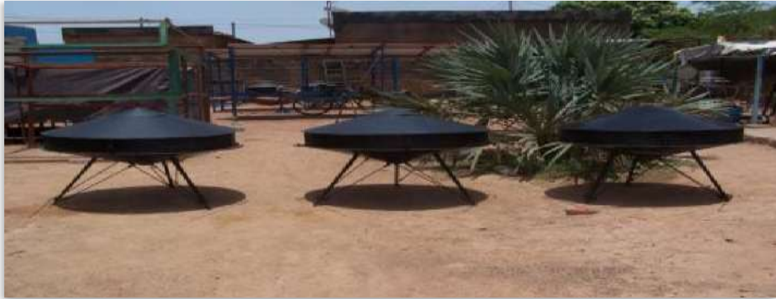
Figure (II.9) : Le séchoir solaire coquillage à trois claies.
