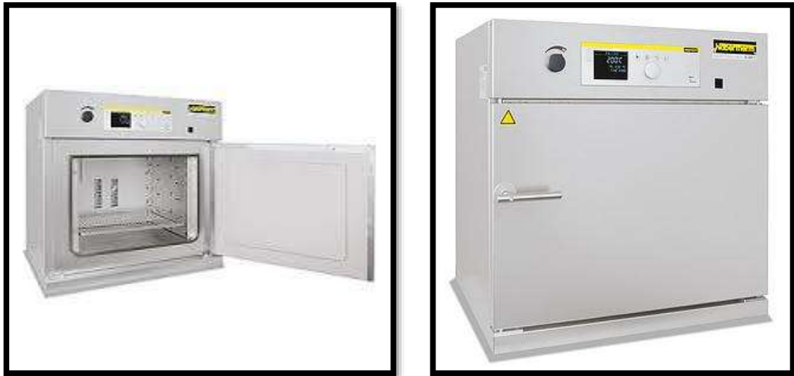
Figure(III-2): Configuration expérimentale( Étuve industrielle à convection forcée)
