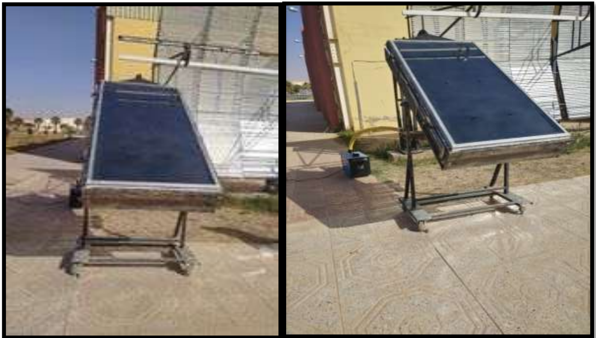
Figure(III-3) : Configuration expérimentale (capteur solaire avec chambre de séchage).
