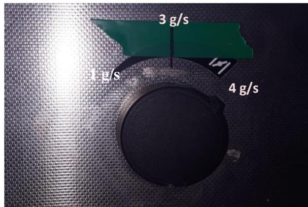
**Fig. (III-14) :** Contrôleur de débit d'air sur l'étuve de séchage Naberterm ( 30-3000°C ).
