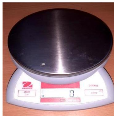
**Fig. (III-11) :** Balance Numérique portable OHAUS CS5000P.
