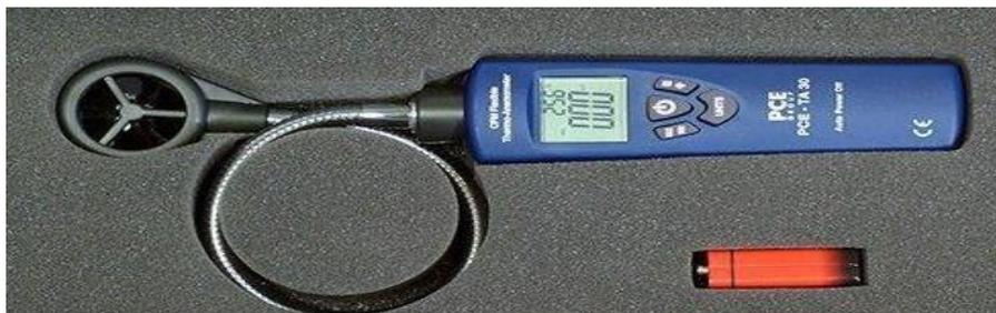
**Fig. (III-5) :** anémomètre numérique (modèle PCE-TA30).
