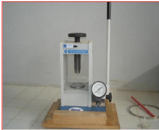
**Fig. II.6** : Appareil de pressage uni axiale.
