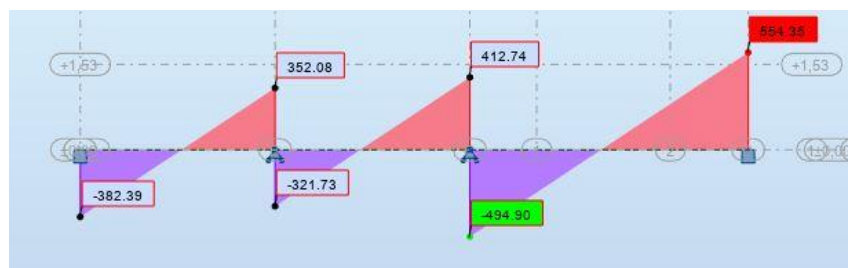
Figure.VI.7 : Diagramme des moments fléchissants ELS
