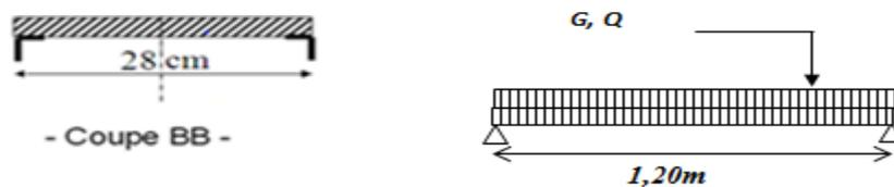
**Fig.III. 3.16 – Schéma statique et section droite d'une cornière porteuse de marche**
