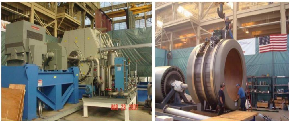
Figure II. 5 Moteur HTC le plus puissant (36,5 MW) jamais construit [32]
