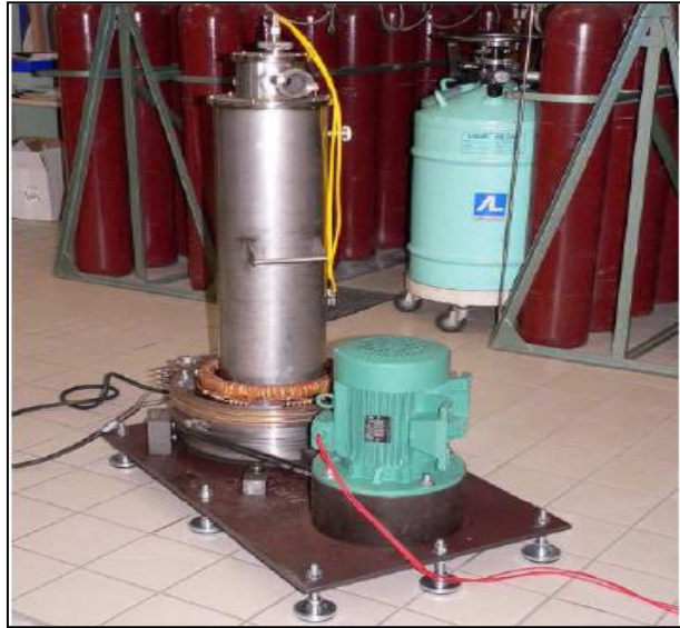
Figure III 29 Moteur supraconducteur à concentration de flux, 20kW-750tr/min [47]
