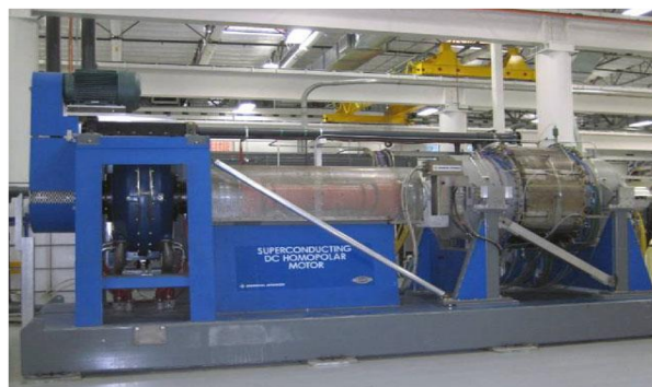
Figure II. 3 Moteur Homopolaire 3,7 MW, GENERAL ATOMICS et sa charge à gauche [27].
