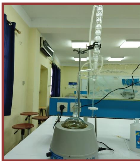
Figure 09 : Montage d'extraction de type clevenger (Photo Originale).
