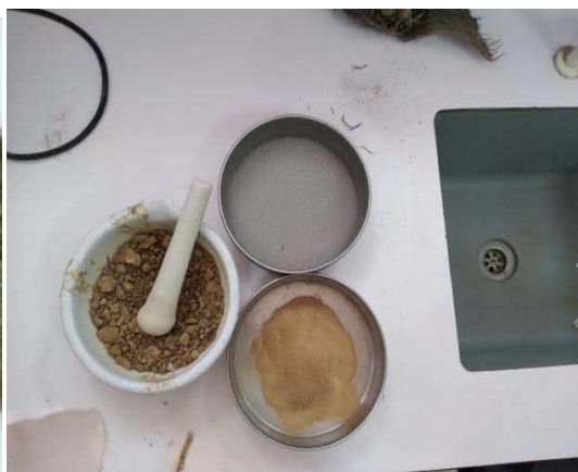
Photo12 : broyage et tamisage du sol.
