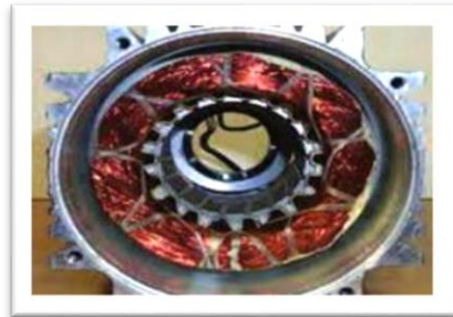
Figure (I.2) : photographie d'un stator [6].
