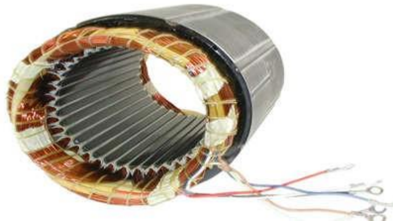
Figure I.2 : schéma présente l'enroulement du stator. [4]
