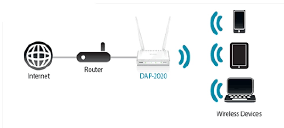
Figure II.8: Point d'accès en mode pont sans fil [19]
