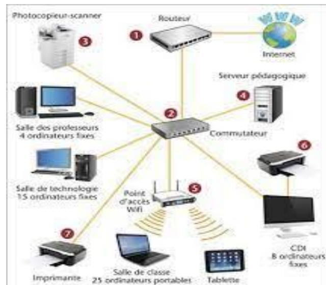
Figure II.1: Composition d'un réseau wifi
