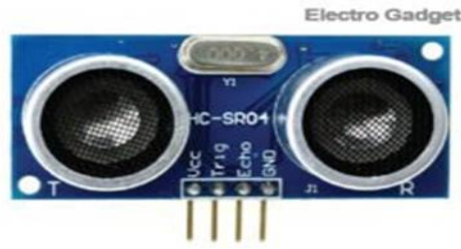
الشكل (21.4): جهاز استشعار بالموجات فوق الصوتية
